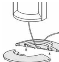
Сначала соберите подставку из двух частей. Пропустите шнур питания через отверстие в центре и установите подставку на вентилятор. Убедитесь, что провод прошел через соответствующее отверстие. Закрепите подставку на вентиляторе с помощью крепежных винтов.
