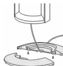
Najpierw należy zmontować dwie połówki cokołu. Następnie przełożyć przewód zasilający przez otwór w środku i zamontować cokół do wentylatora. Przewód musi zostać prowadzony przez przepust kablowy. Następnie przymocować cokół do wentylatora za pomocą śrub montażowych.
