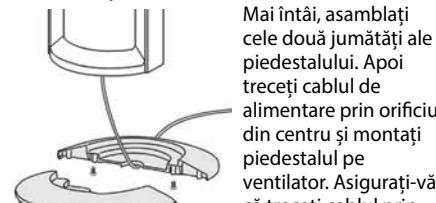
Mai întâi, asamblați cele două jumătăți ale piedestalului. Apoi treceți cablul de alimentare prin orificiul din centru și montați piedestalul pe ventilator. Asigurați-vă că treceți cablul prin orificiul de intrare a cablului. Apoi fixați piedestalul la ventilator folosind șuruburile de montare.
