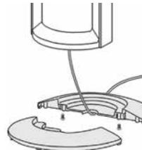
Najprej sestavite obe polovici podstavka. Nato napajalni kabel speljite skozi luknjo na sredini in podstavek pritrjdite na ventilator. Prepričajte se, da ste kabel speljali skozi vhod za kabel. Nato podstavek pritrjdite na ventilator z montažnimi vijaki.
