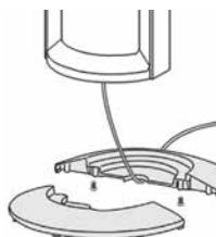
Pour commencer, assemblez les deux moitiés du pied. Passez ensuite le cordon d'alimentation à travers le trou au centre et installez le pied sur le ventilateur. Assurez-vous de faire passer le câble à travers l'entrée prévue pour le câble. Fixez ensuite le pied au ventilateur à l'aide des vis de montage.
