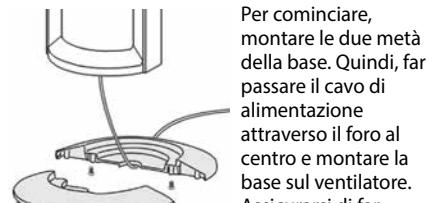
Per cominciare, montare le due metà della base. Quindi, far passare il cavo di alimentazione attraverso il foro al centro e montare la base sul ventilatore. Assicurarsi di far passare il cavo attraverso l'apposito ingresso. Quindi, fissare la base al ventilatore con le viti di montaggio
