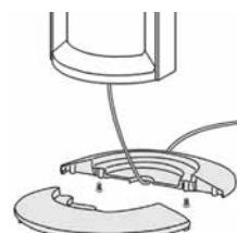
Sätt först ihop fotens två halvor. För sedan strömkabeln genom hålet i mitten och montera foten på fläkten. Se till att du för kabeln genom kabelgenomföringen. Fäst sedan foten på fläkten med hjälp av monteringskruvarna.
