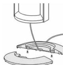
Najpre sastavite dve polovine postolja. Zatim provucite kabl za napajanje kroz otvor u centru postolja i nosač do ventilatora. Vodite računa da uvedete kabl kroz uvod za kabl.
