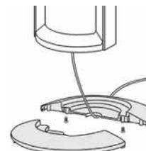
Спочатку з'єднайте дві половини основи. Потім проведіть шнур живлення через отвір посередині та приєднайте основу до вентилятора. Обов'язково проведіть кабель через отвір для кабелю. Потім прикріпіть основу до вентилятора за допомогою кріпильних гвинтів.
