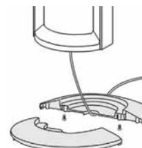
Setzen Sie zuerst die beiden Hälften des Standfußes zusammen. Führen Sie dann das Netzkabel durch das Loch in der Mitte und befestigen Sie den Standfuß am Ventilator. Achten Sie darauf, dass Sie das Kabel durch die Kabeldurchführung verlegen. Befestigen Sie dann den Standfuß mit den Befestigungsschrauben am Ventilator.
