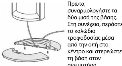
Βεβαιωθείτε ότι έχετε περάσει το καλώδιο μέσα από την είσοδο για το καλώδιο. Στη συνέχεια, στερεώστε τη βάση στον ανεμιστήρα χρησιμοποιώντας τις βίδες στερέωσης.
