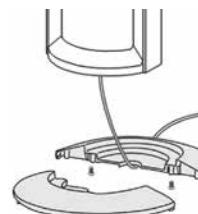
Primero, ensamble las dos mitades del pedestal. A continuación, pase el cable de alimentación por el orificio en el centro y Monte el pedestal en el ventilador. Asegúrese de dirigir el cable por la entrada para el cable. A continuación, fije el pedestal al ventilador usando los tornillos de montaje.
