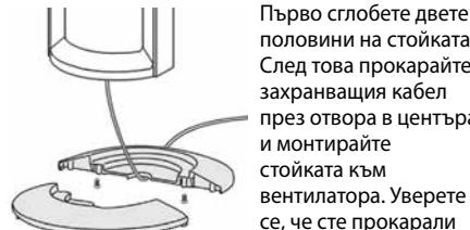
Първо сглобете двете половини на стойката. След това прокарайте захранващия кабел през отвора в центъра и монтирайте стойката към вентилатора. Уверете се, че сте прокарали кабела през входа за кабела. След това фиксирайте стойката към вентилатора като използвате монтажни винтове.
